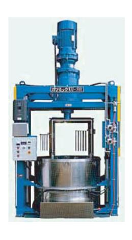
パウダー、難燃ブレンド完了時間20分(参考値) 低速回転で、タンク羽根のこびりつきが少ない 小型モーター使用で、エネルギー節約 回転羽根は、無段階変速 原料の供廻り防止用センターポール、内フィン装備 羽根、底クリアランスをワンタッチ調整 駆動ユニット800mm上昇(KU-500) タンク蓋セットで、飛散なし 移動フレーム落下防止安全装置 排出ダンパーロック機構 運転中一時停止時、タイマー残り時間キープ機能
