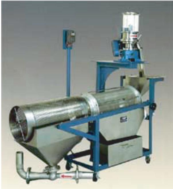
振動式選別機のリスクである静電気の発生を、回転式の採用で抑制しました。切り粉がペレットに付着せずに払い落とされます。ペレット同士も繋がらず、選別精度が向上します。
